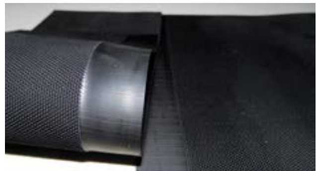
Vorbereitete Verbindung für das Staubabdichtungssystem.
