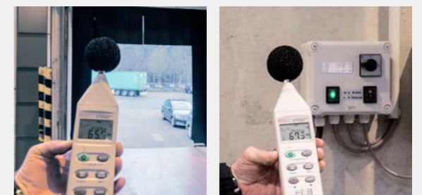
Måling af støjniveauet, når luftforhængssystemet kører ved fuld belastning
