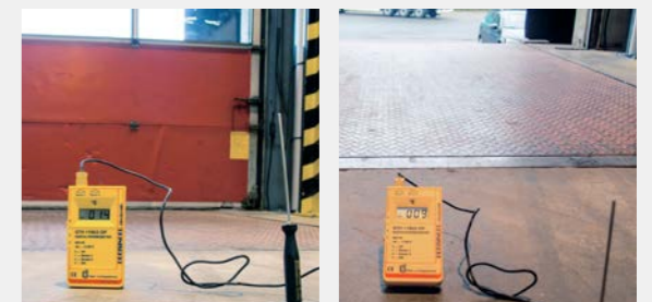
Måling af haltemperatur og luftindstrømningshastighed for kold luft
