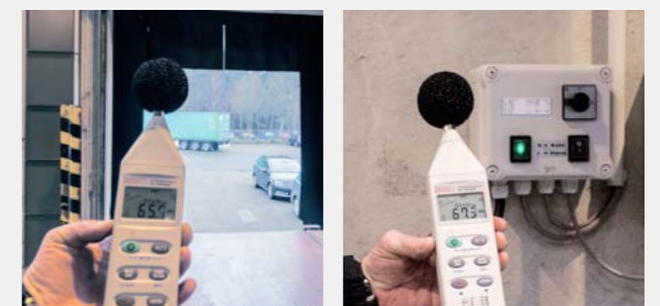
Messung des Geräuschpegels bei laufender Luftvorhanganlage in Vollast
