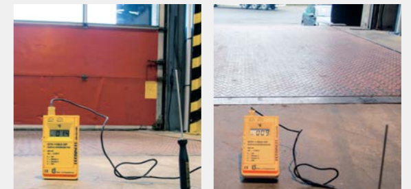
Измерение температуры воздуха в помещении и скорости входящего потока холодного воздуха
