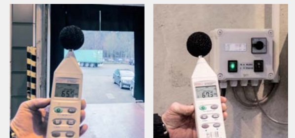
Измерение уровня шума при работающей системе воздушной завесы в режиме полной нагрузки
